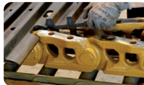
Chaînes meulées avant la pose de tuiles
