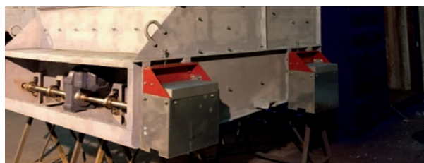
Moto-réducteur et capotage des roues
