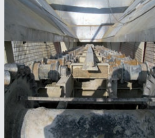
Démontage de la chaîne usée. Vérification de l'état des galets
